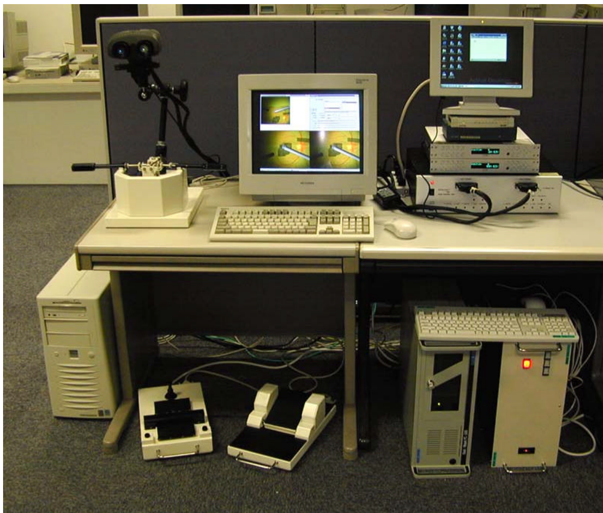
図 7-16 PC ベース手術シミュレータの構成
